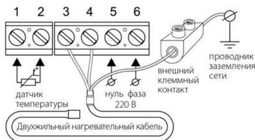
Схема подключения нагревательного кабеля «РУССКОЕ ТЕПЛО» РТ
