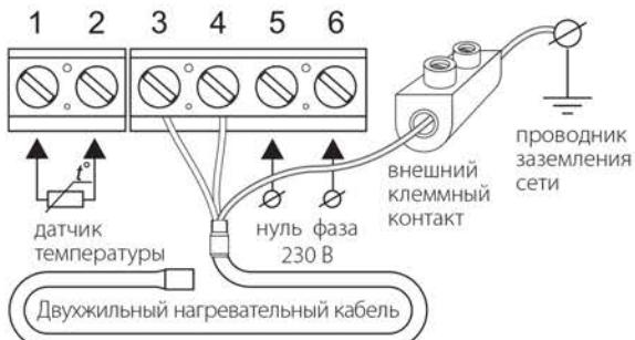
Схема подключения нагревательного кабеля
