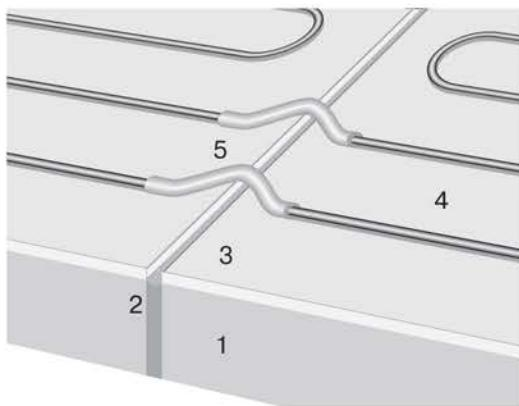
**В случае установки секции на деревянном полу:** надежно закрепите доски пола, накройте водостойкой фанерой (ГВЛ или аналогичным материалом) толщиной 18 мм и прикрепите винтами, чтобы обеспечить надежное устойчивое основание. Укладка фанеры на балках или лагах не рекомендуется, т. к. не обеспечит механической прочности. Важно обеспечить прочное основание, чтобы предотвратить возникновение трещин в слое раствора или клеевой смеси, острые края которых могут повредить нагревательный кабель.
