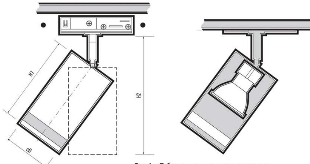
*Рис.1 Габаритные размеры и разрез светильника PTR 28*
