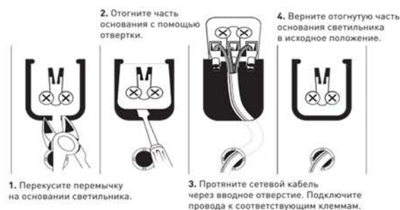
Рис.1. Схема подключения светильника к сети 230В.
