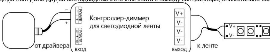
ПРЕДУПРЕЖДЕНИЕ: ЗАПРЕЩЕНО ОСУЩЕСТВЛЯТЬ ОДНОВРЕМЕННОЕ ПОДКЛЮЧЕНИЕ ИСТОЧНИКОВ ПИТАНИЯ ЧЕРЕЗ РАЗЪЕМ И ЧЕРЕЗ КЛЕММНУЮ КОЛОДКУ.
