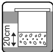
5.4 Проверьте работоспособность дренажной системы. Для это заполните монтажную лунку водой и проверьте удалилась ли вода за 30 минут. Если этого не произошло, то увеличьте высоту дренажной системы, либо рассмотрите возможность монтажа водоотводящего трубопровода.
