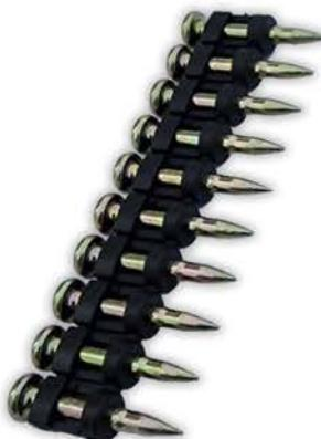
Кованые гвозди выполнены в форме пули, с плавным утолщением материала от острия к шляпке гвоздя. Такая форма гвоздя достигается путем прокатки наконечника гвоздя в сдавливающих роликах. Это позволяет уплотнить металл в зоне, где располагается острие и создать гвоздь в виде пули (баллистической формы). Благодаря увеличенной плотности наконечника гвоздя, им можно пробивать материалы повышенной прочности, не оставляя при этом за собой строительного мусора.
