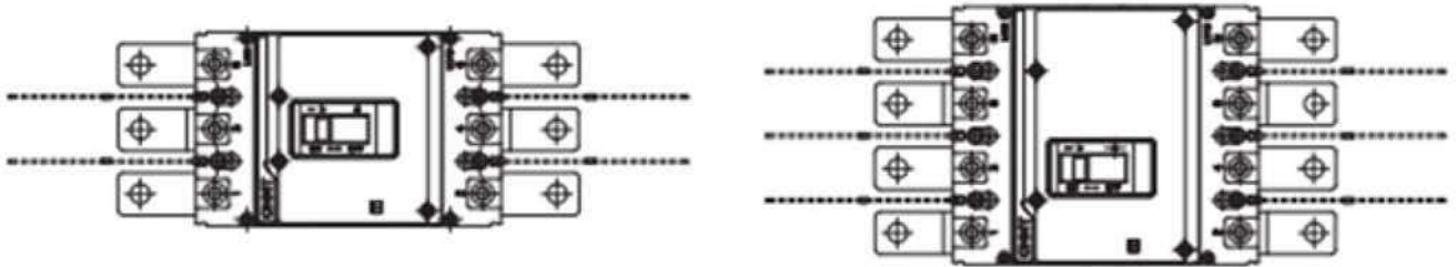
Рисунок 9. Схема установки соединительной пластины NXM(S)-63, 125, 160, 250
