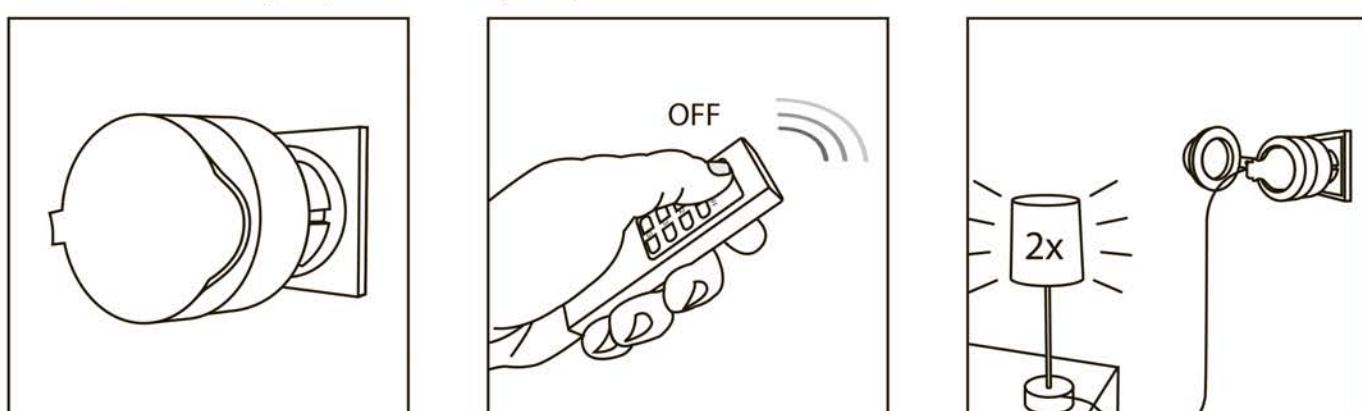
Рисунок 7. Пример отключения пультов РУ3, РУ6 от приемника РЗК.
