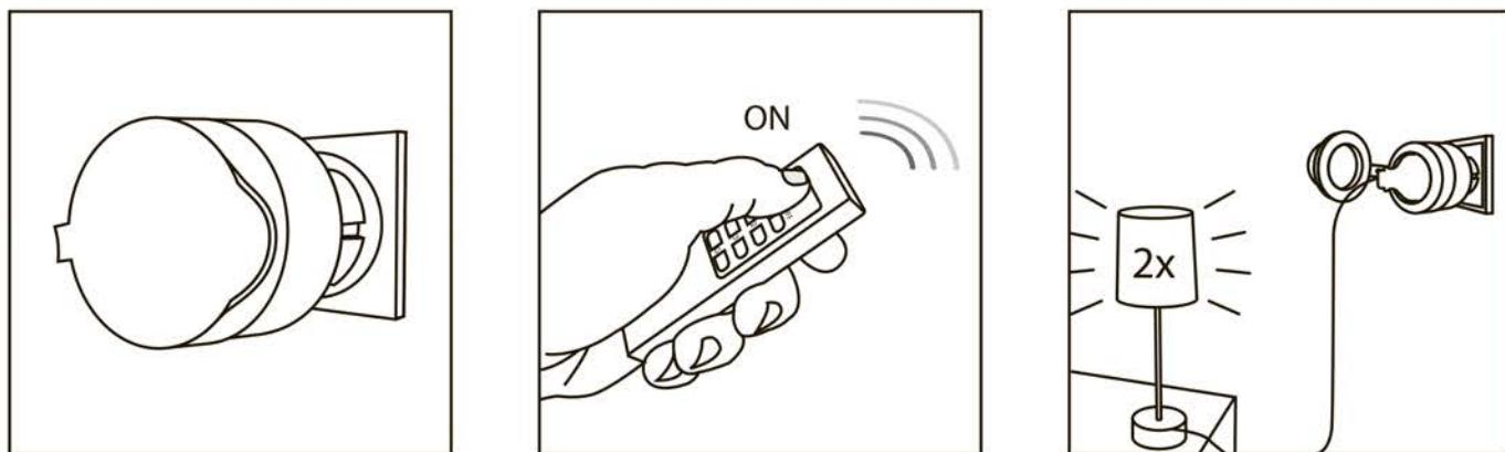
Рисунок 6. Пример подключения пультов РУ3, РУ6 к приемнику РЗК.
