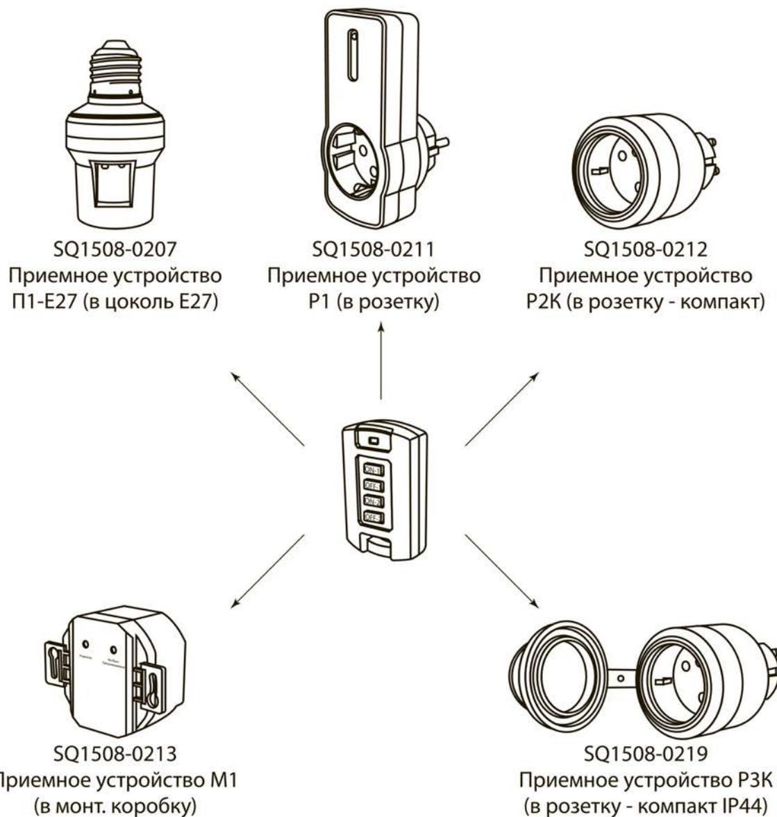
Рисунок 4. Подключение приемников из линейки «Уютный дом» к ПУб.
