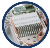
13 пластин в дугогасительной камере эффективно гасят дугу и обеспечивают безопасное отключение в аварийной ситуации.
