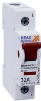
Выключатели нагрузки типа OptiDin BM63PL (далее «выключатели») предназначены для применения в электрических цепях напряжением до 400 В переменного тока частоты 50/60 Гц, проведения тока в нормальном режиме и оперативных включений и отключений указанных цепей под нагрузкой. Выключатели соответствуют требованиям ГОСТ IEC 60947-3, ТР ТС 004/2011, ТР ЕАЭС 037/2016.
