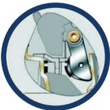
Серебросодержащие напылки на подвижном контакте для повышения износостойкости и уменьшения значения переходного сопротивления.
