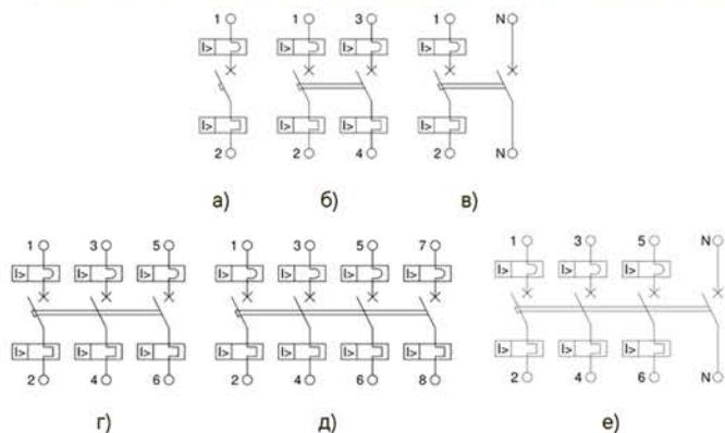
а) однополюсного; б) двухполюсного с двумя защищенными полюсами;
