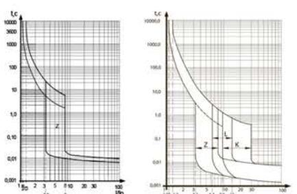
Рисунок Б.4 Защитные характеристики в цепи постоянного тока по ГОСТ IEC 60947-2 при контрольной температуре плюс 30°C.
