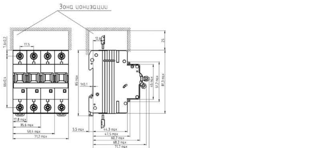
Рисунок В.1– Габаритные и установочные размеры выключателей
