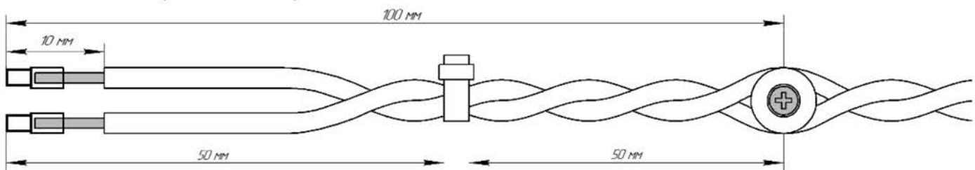
5.2.7. Присоединить проводники подводимого провода к соответствующим контактам розетки плотно закрепить проводники с помощью отвертки. Важно при подключении проследить, чтобы провода в зажиме были хорошо затянуты.
