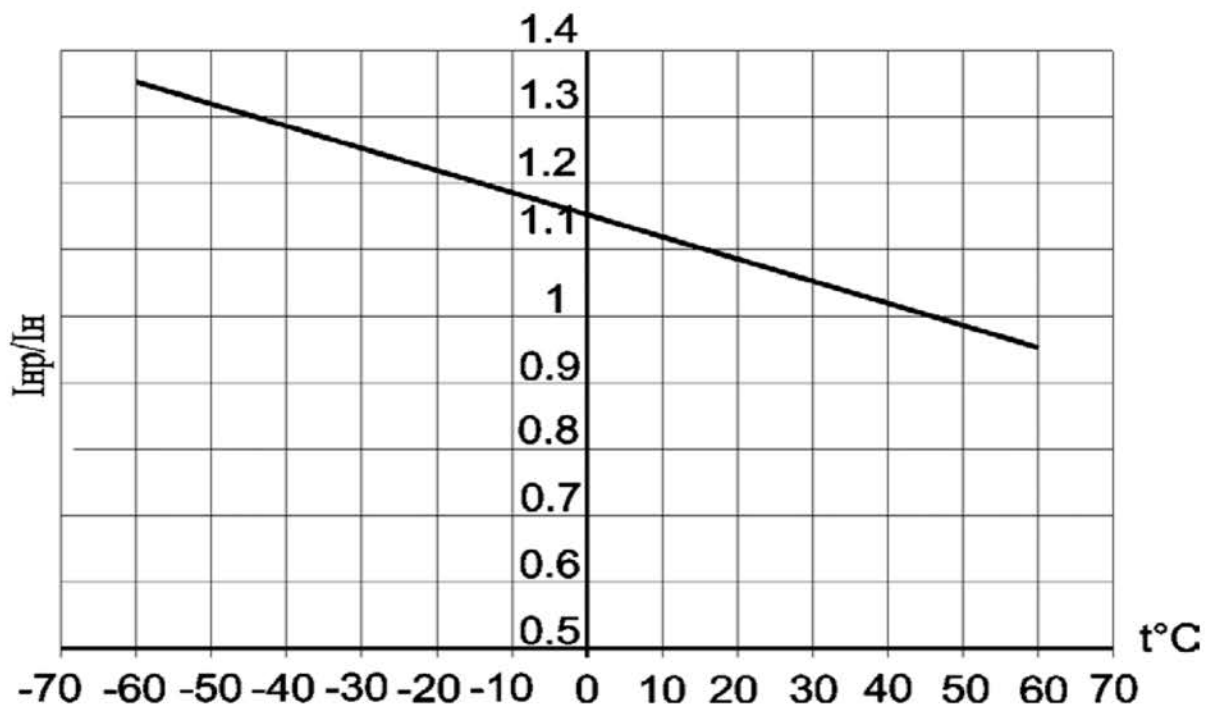
Рисунок 2 - Зависимость номинальных рабочих токов выключателей с приёмкой РС от температуры окружающей среды
