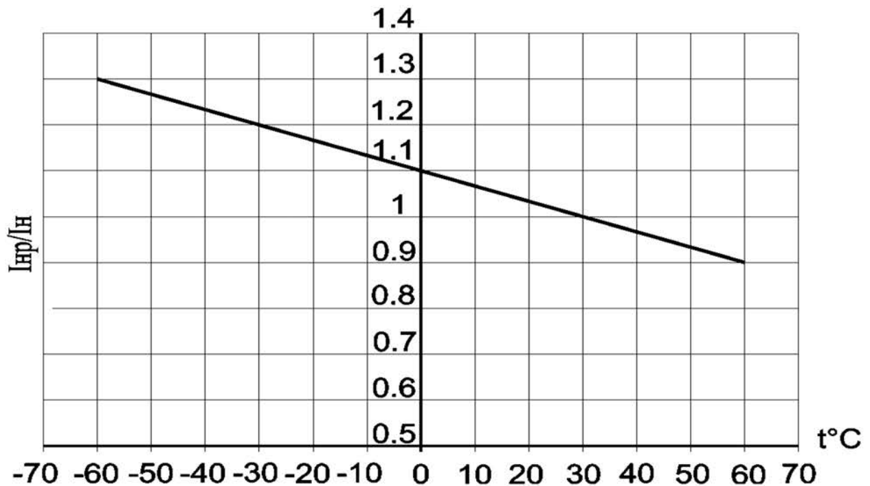
Рисунок 1 - Зависимость номинальных рабочих токов выключателей от температуры окружающей среды
