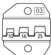
Опрессовка одинарных изолированных и неизолированных втулочных наконечников
