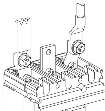
Автоматические выключатели ВА-99С/100-630А EKF PROxima имеют контактные выводы с защелкивающимися гайками и зажимными винтами (ВА-99С/100-250А: М8, ВА-99С/400-630А: М10). Они обеспечивают непосредственное присоединение изолированных шин или кабелей с наконечниками к аппарату. Дополнительные контактные пластины позволяют осуществлять любое присоединение.
