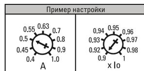
Значение уставки защиты от перегрузок для аппарата ВА-99С 400А при I<sub>0</sub> = 0,5 и I<sub>r</sub> = 0,9 будет  $400 \times 0,5 \times 0,9 = 180 \text{ А}$ .
