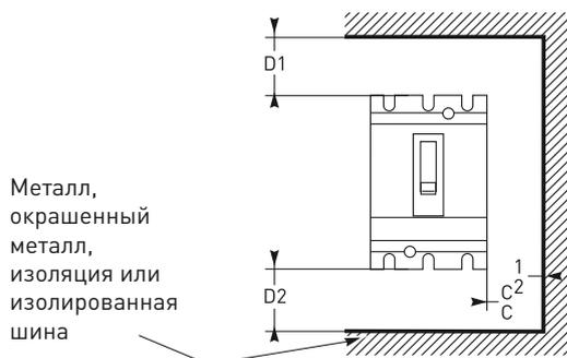
Минимальное расстояние между автоматическим выключателем и передней, задней панелью.
