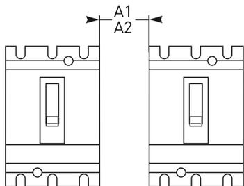
Минимальное расстояние между автоматическим выключателем и нижней, верхней или боковой панелью.
