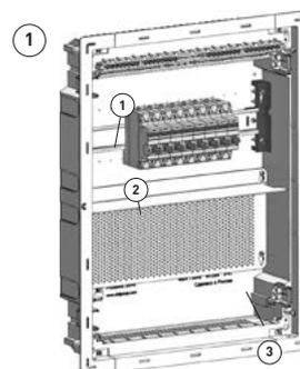
\* Монтажная плата (арт. profibox-mp-s) и перегородка отсеков (арт. profibox-s) приобретаются отдельно
