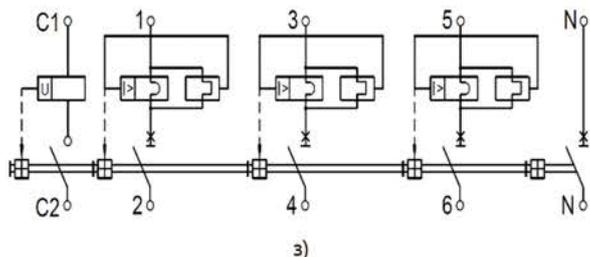
а) однополюсного; б) двухполюсного с двумя защищенными полюсами; в) трехполюсного; г) четырехполюсного с тремя защищенными полюсами; д) однополюсного с модулем независимого расцепителя; е) двухполюсного с двумя защищенными полюсами с модулем независимого расцепителя; ж) трехполюсного с модулем независимого расцепителя; з) четырехполюсного с тремя защищенными полюсами с модулем независимого расцепителя.
