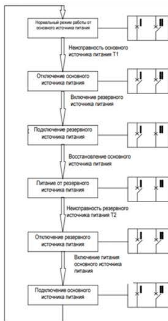
Блок-схема автоматического заряда без автоматического возврата (сеть – сеть)
