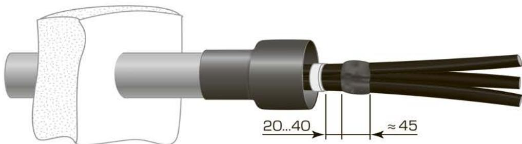
**3.2.2** С усилием сжать герметизируемые кабели вместе, наложить бандаж из киперной ленты, как показано на рисунке. Другой частью герметика заполнить пустоты между кабелями по наружной поверхности.
