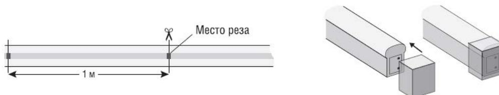
На незадействованные концы ленты необходимо установить силиконовые заглушки (в комплекте поставки). При установке заглушек, для обеспечения герметизации, рекомендуется использовать специальный клей-герметик.
