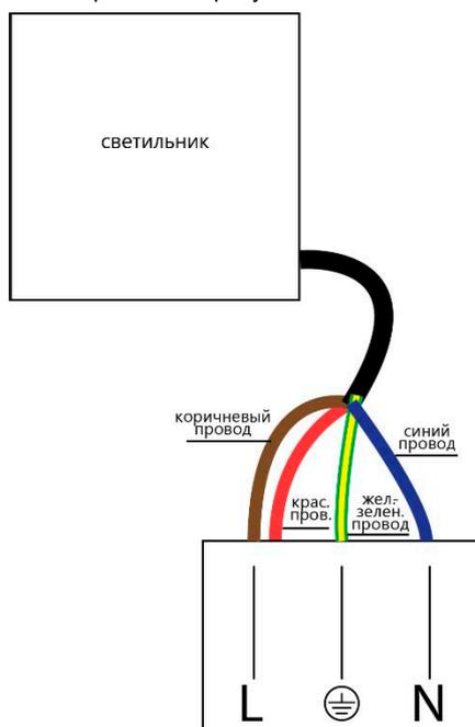
Рис. 2 Схема подключения
