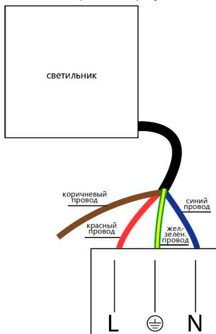
Рис. 1 Схема подключения
