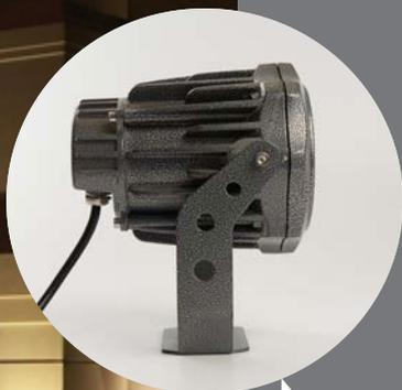
Светодиодные прожекторы для архитектурной и фасадной подсветки используются в художественной подсветке фасадов зданий, колонн, ниш. За счет направленного света с углом свечения 15° или 23° можно подсвечивать определенные архитектурные элементы. Специальная скоба, на которой закреплен светодиодный прожектор, позволяет поворачивать светильник в двух плоскостях.
