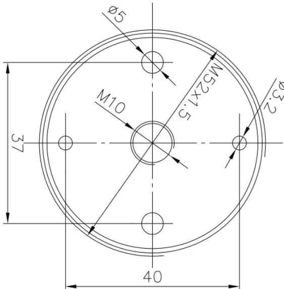
Рис. 1 Схема основания светильников ML181, ML182
