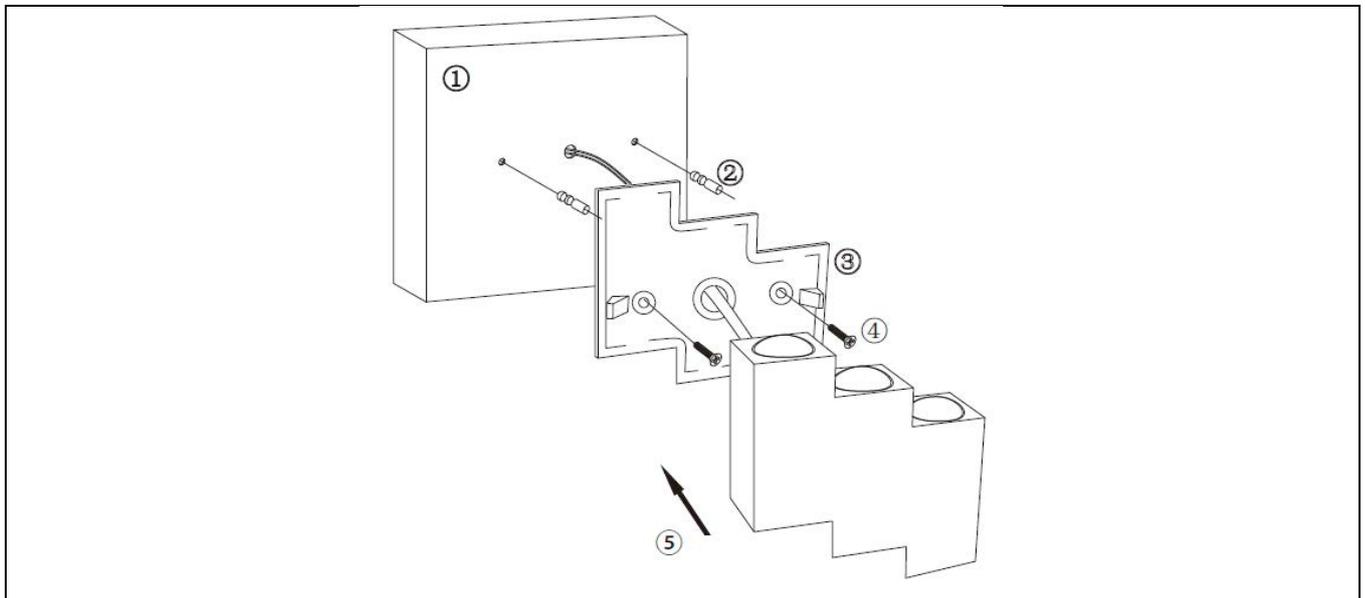
1. Снимите основание светильника, выкрутив сбоку два удерживающих винта. Для этого используйте шестигранный ключ на 2.
