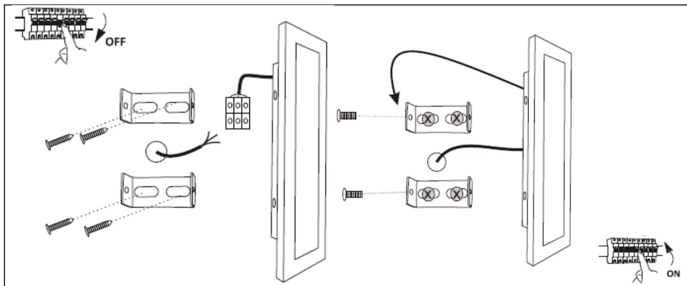
1. Разметьте монтажную поверхность, просверлите в монтажной поверхности необходимые отверстия и вставьте в отверстия пластиковые дюбели. Затем закрепите крепежные скобы светильника на монтажной поверхности при помощи саморезов.
