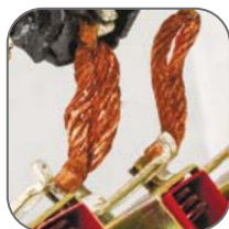
Внутренние токоведущие части из электротехнической меди
