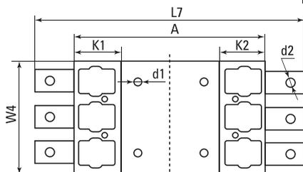
Панель выкатная PM-99M/1 с передним/задним присоединением 400–800А
