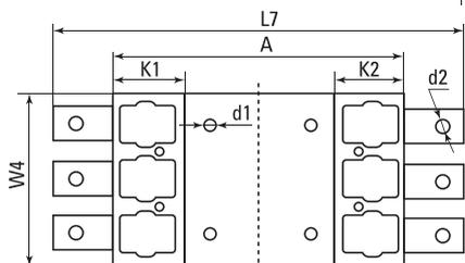
Панель выкатная PM-99M/1 с передним/задним присоединением 400–800А
