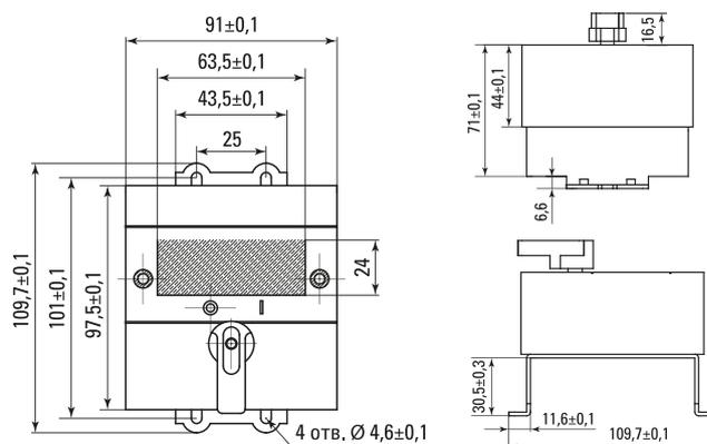
**Моторный привод 230В AC к ВА-99М 250 EKF PROxima**
