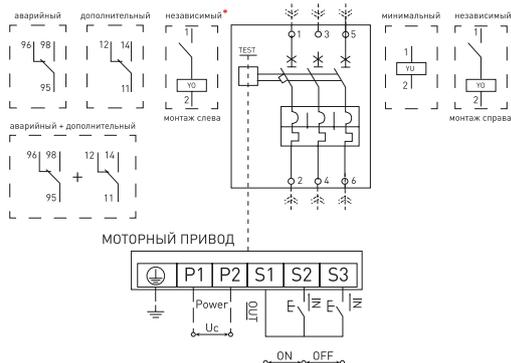
\* Независимый расцепитель реализован в двух исполнениях: монтаж слева и монтаж справа. Возможна установка только одного аксессуара с каждой стороны.
