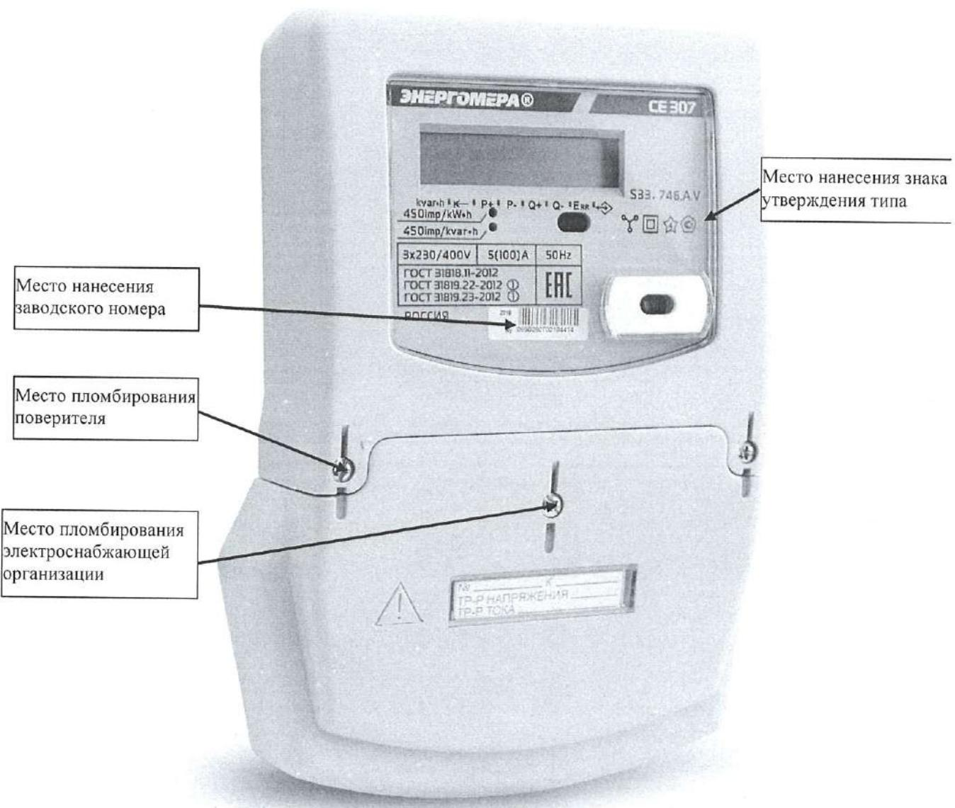
Рисунок 10 – Общий вид счетчика СЕ307 S33\*
