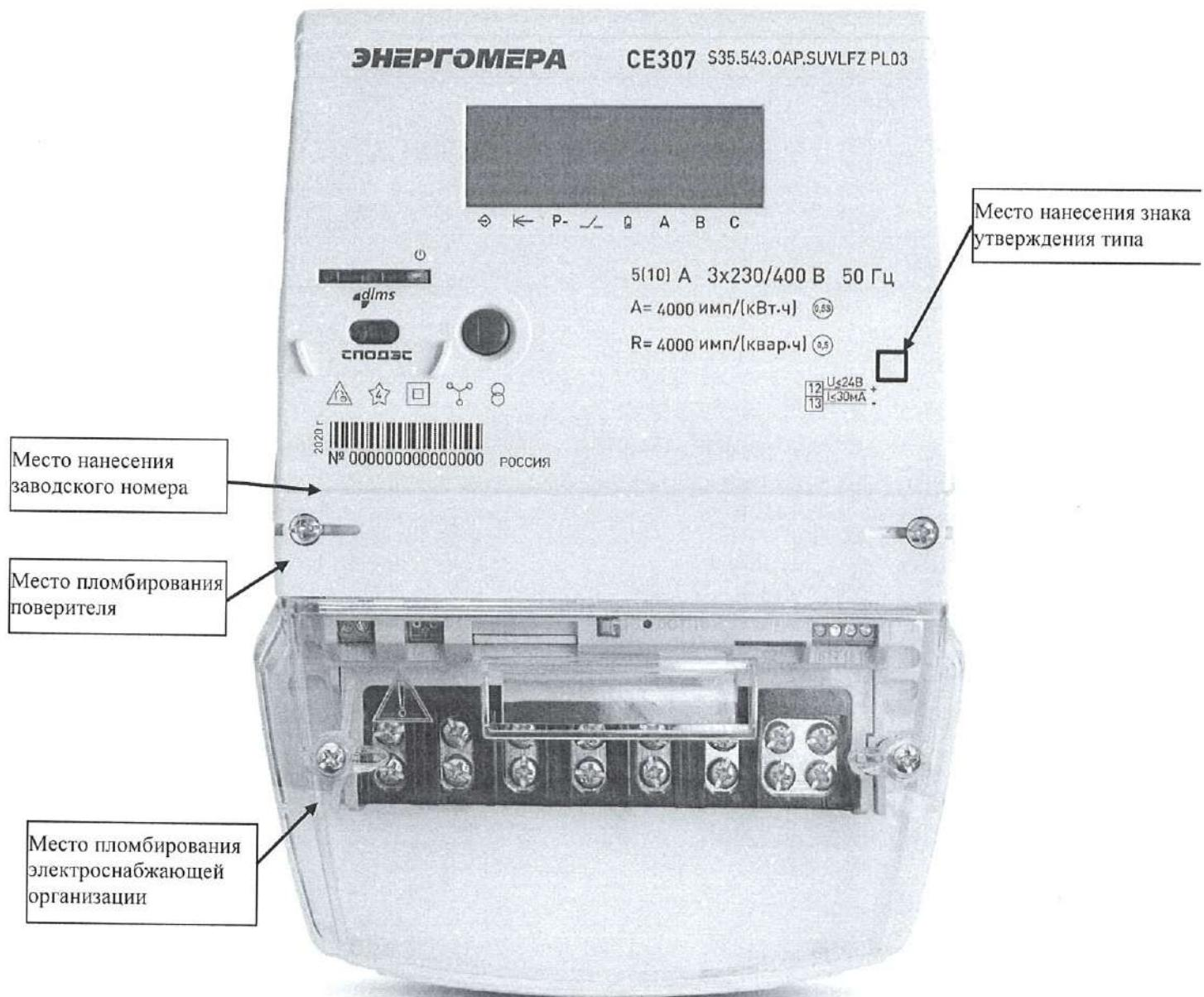
Рисунок 7 – Общий вид счетчика СЕ307 S35 исполнение 2\*
