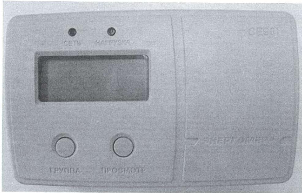
Рисунок 12 – Общий вид устройства считывания счетчиков СЕ901
