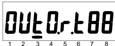
Рисунок 50 - Окно при настройке выхода на режим реле. Реле находится в состоянии «сработало».
