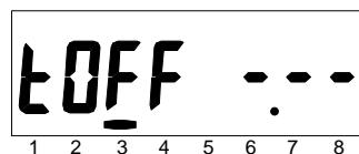
Рисунок 9 – Окно состояния превышения лимита мощности. Превышения нет.
