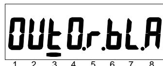
Рисунок 51 - Окно при настройке выхода на режим реле. Реле находится в состоянии «сработало».
