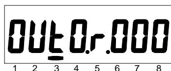
Рисунок 13 - Окно состояния испытательного выхода. Режим реле
