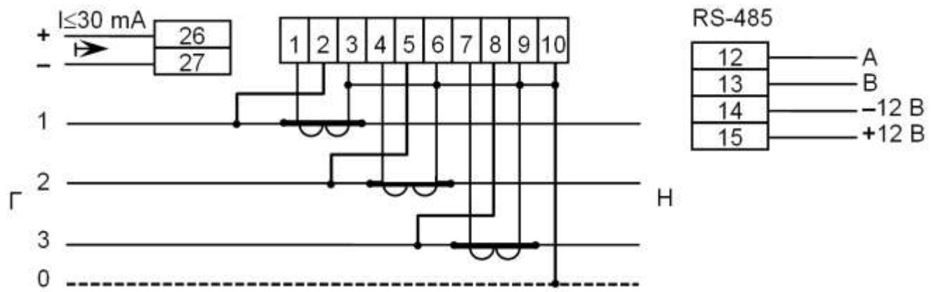
Схема включения счетчиков CE307 R33.145.O, CE307 R33.145.OA.N, CE307 R33.146.O,
