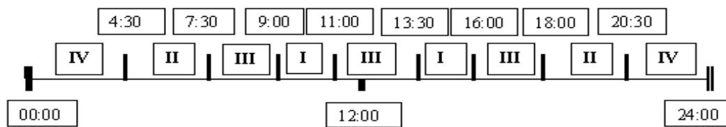
Рисунок 33 - Пример построения суточного расписания переключения тарифов
