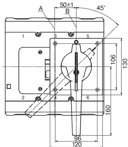
А - вертикальная ось автоматического выключателя;
