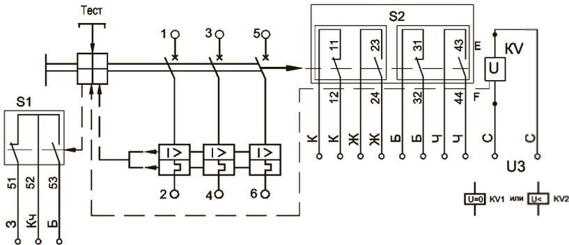
**Автоматические выключатели ВА51-39-XX4730 стационарного исполнения с электромагнитным приводом, независимым расцепителем, вспомогательными контактами сигнализации автоматического отключения и вспомогательными контактами**
