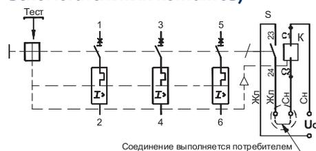
**Автоматические выключатели ВА51-39-XX5610 (16) с нулевым или минимальным расцепителем напряжения, вспомогательными контактами сигнализации автоматического отключения и вспомогательными контактами**
