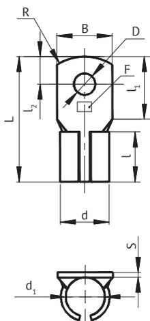
Форма и размеры присоединяемой шины
