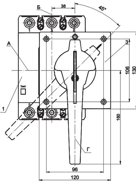
А - горизонтальная ось ручного привода и автоматического выключателя;
