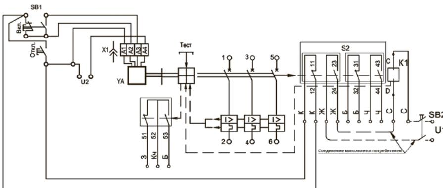
**Схемы электрические принципиальные присоединения внешних проводников к зажимам автоматических выключателей в цепях постоянного тока**
