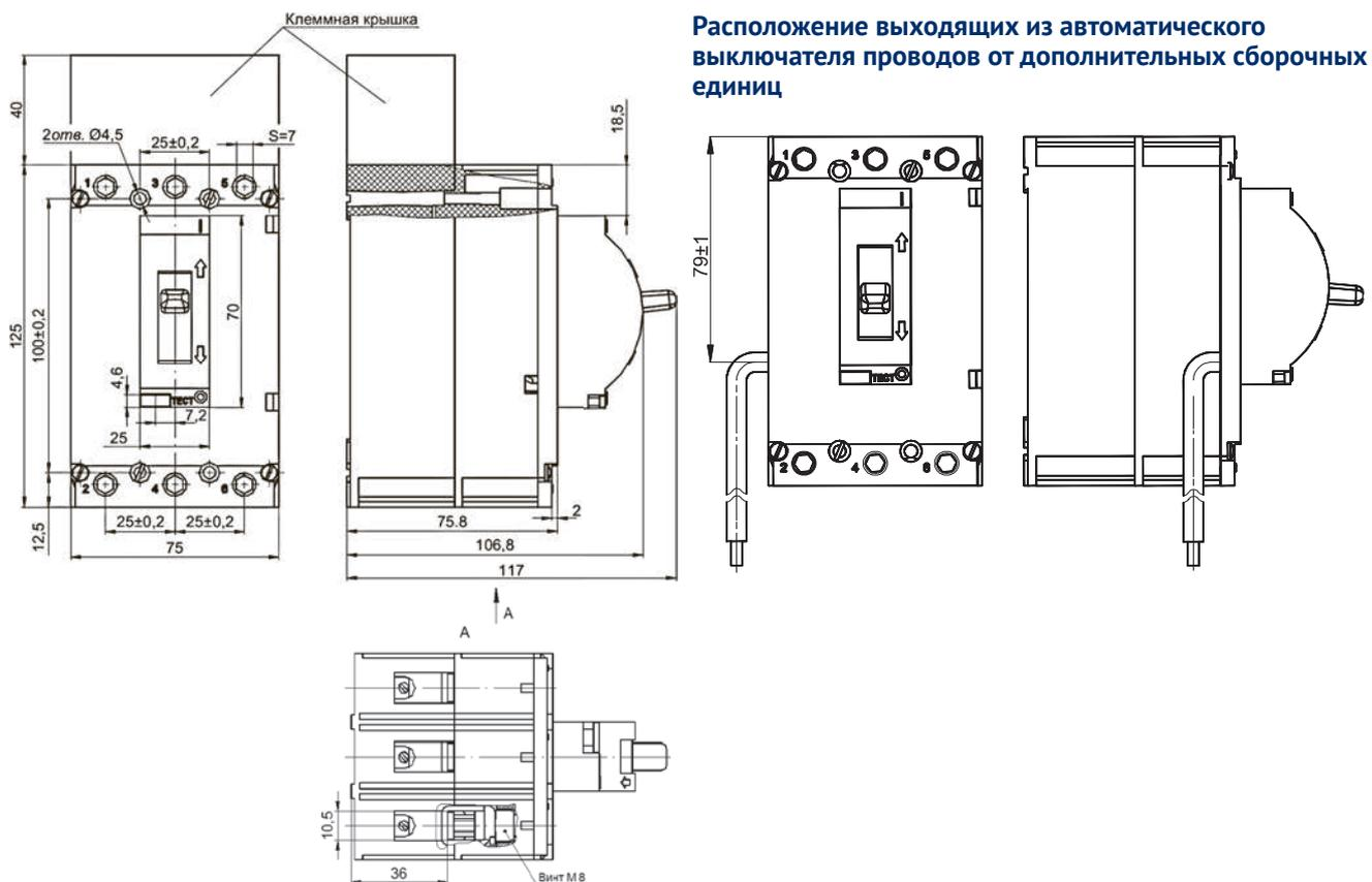
С автоматическим выключателем ВА57-31 комплектно поставляется клеммная крышка, устанавливаемая со стороны выводов 1, 3, 5. Клеммные крышки можно заказать отдельно.
