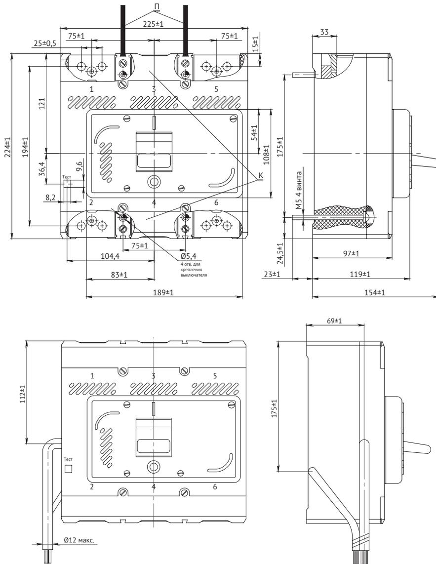
**Стационарного исполнения с электромагнитным приводом**
