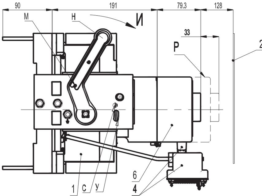
**Автоматический выключатель ВА57-39 выдвижного исполнения с ручным приводом**
