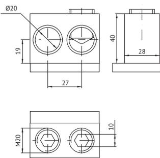
**Зажим для переднего присоединения четырех кабелей сечением до 120 мм<sup>2</sup>**
