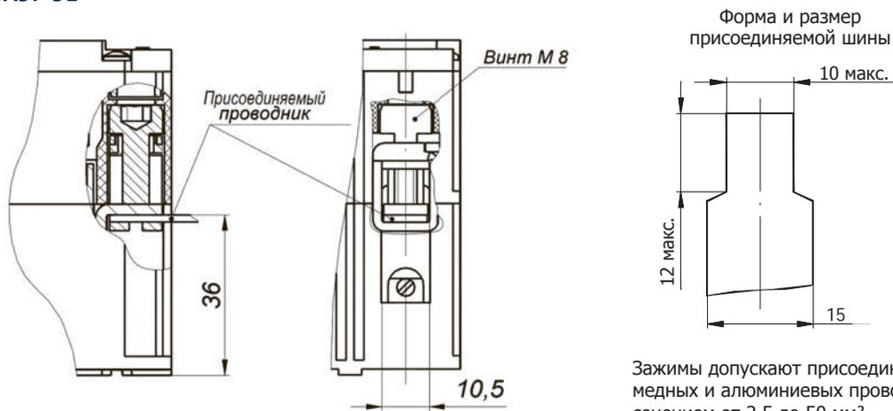
Зажимы допускают присоединение медных и алюминиевых проводников сечением от 2,5 до 50 мм<sup>2</sup>
