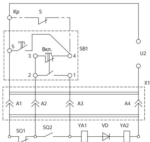
Схема электромагнитного привода приведена для автоматического выключателя в положении отключено.
