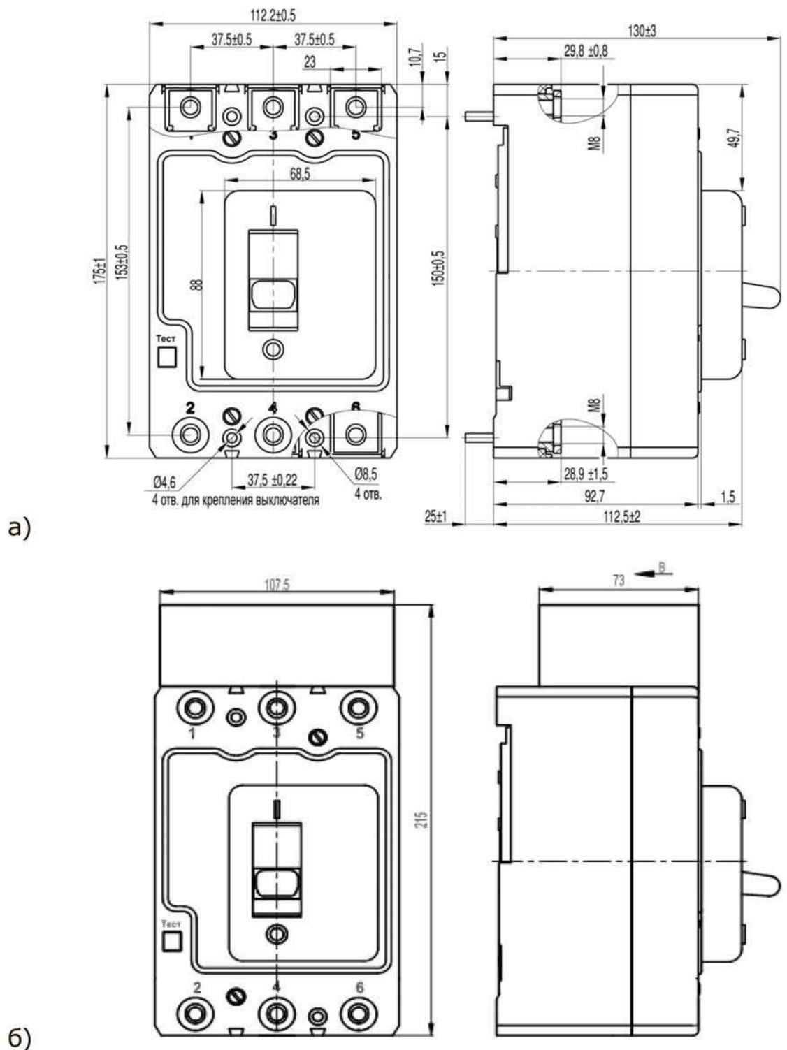
**Рисунок Б.1 – Выключатель ВА57-35 с зажимами для переднего присоединения**
