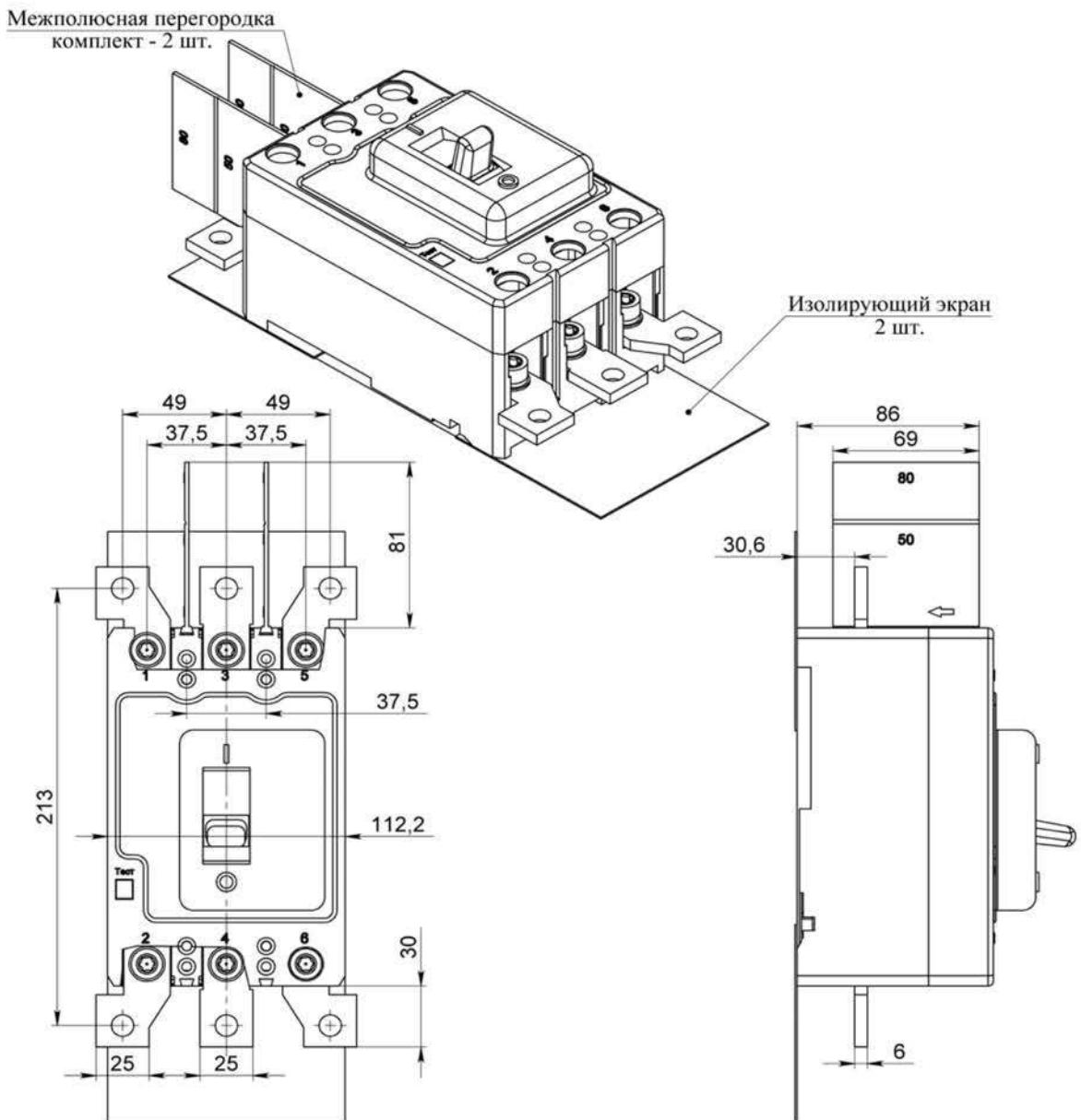
**Рисунок Д.26** – Присоединение с расширительными выводами, межполюсными перегородками и изолирующими экранами
