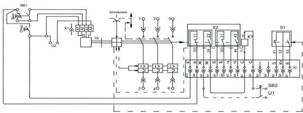
**Рисунок Г.5** - Схема электрическая принципиальная выключателей выдвижного исполнения, с независимым расцепителем, вспомогательными контактами сигнализации автоматического отключения и электромагнитным приводом
