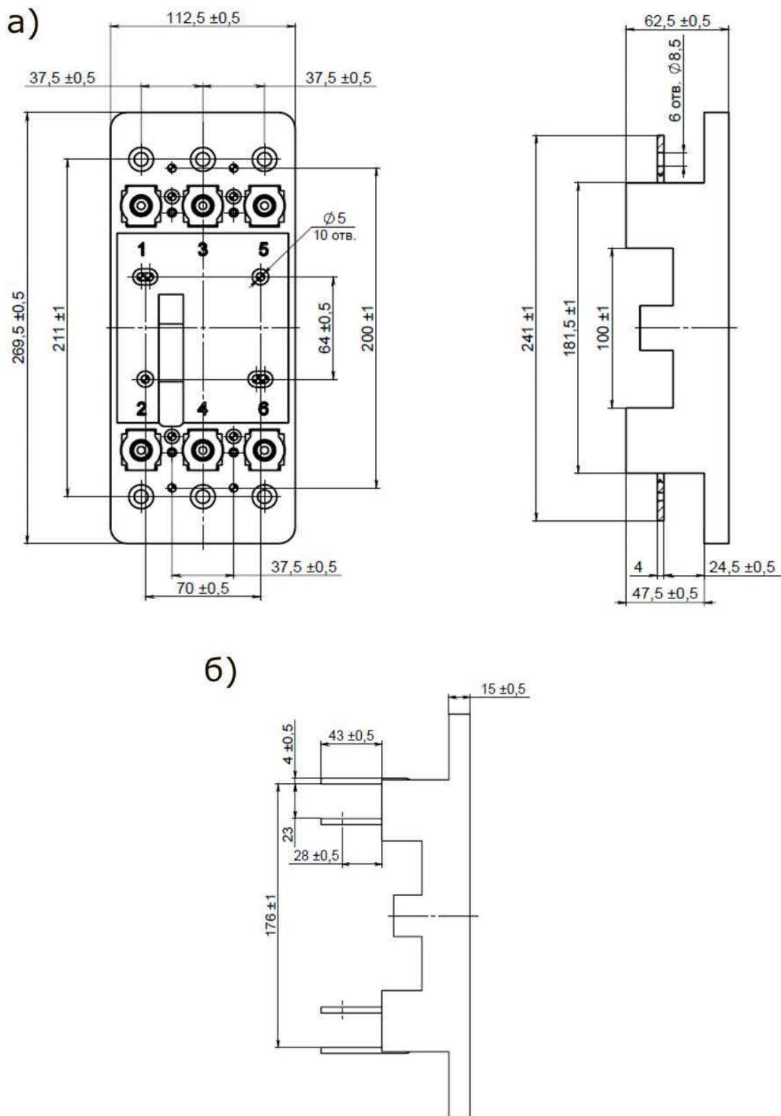
**Рисунок Б.9** - Панель втыччная ВА57-35
