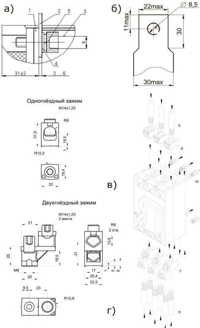
1 – вывод выключателя, 2 – шина (или кабельный наконечник), 3 – выключатель, 4 – шайбы, 5 – винт M8, 6 – одногнездный зажим, 7 – двухгнездный зажим, 8 – винт M8, 9 – присоединяемый проводник, 10 – втулка (используется со стороны выводов 1, 3, 5).
