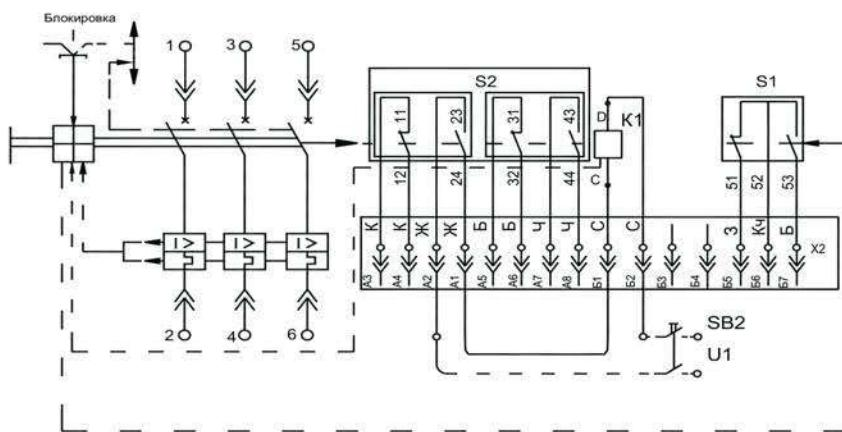
**Рисунок Г.6** - Схема электрическая принципиальная выключателей выдвижного исполнения, с независимым расцепителем, вспомогательными контактами сигнализации автоматического отключения
