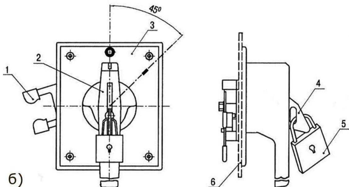
**Рисунок Б.14 – Запирающее устройство в положении «Отключено»**
