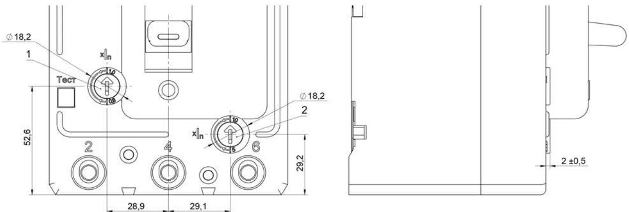
**Рисунок 1** – Выключатель с регулируемыми максимальными расцепителями .
