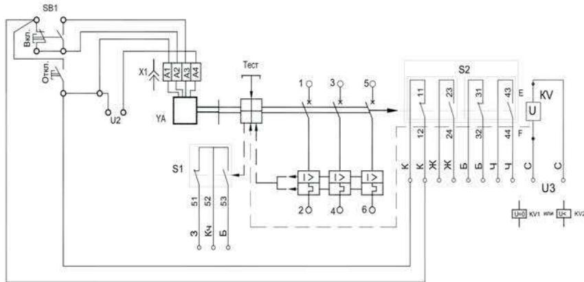
**Рисунок Г.4** - Схема электрическая принципиальная выключателей стационарного исполнения, с нулевым или минимальным расцепителем напряжения, вспомогательными контактами сигнализации автоматического отключения, вспомогательными контактами и электромагнитным приводом
