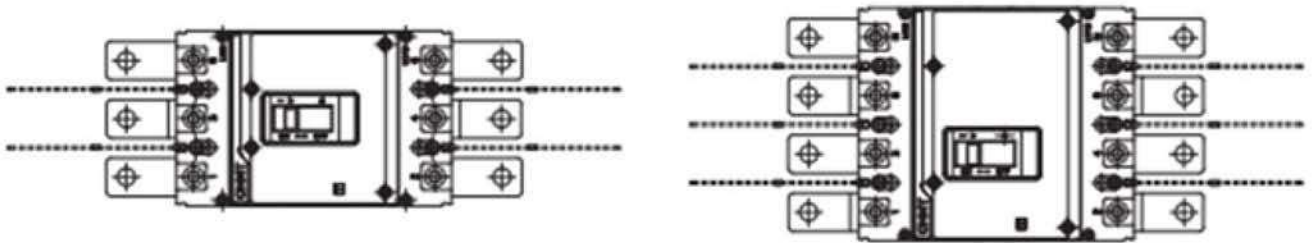
Рисунок 9. Схема установки соединительной пластины NXM(S)-63, 125, 160, 250
