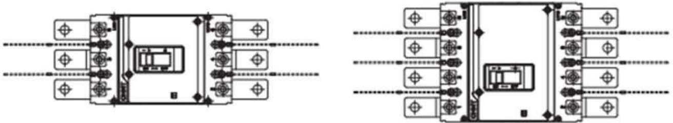
Рисунок 9. Схема установки соединительной пластины NXM(S)-63, 125, 160, 250
