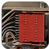
11 пластин в дугогасительной камере
