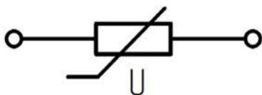
**Рисунок Б.8** – Ограничители перенапряжений топов: ОПН-221, ОПН-222, ОПН-223
