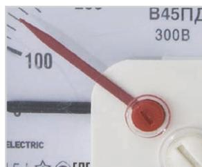
Приборы имеют дополнительную красную стрелку-указатель, которая позволяет вручную зафиксировать максимальное значение, которое показал данный прибор, или установить необходимый контролируемый уровень напряжения или тока.
