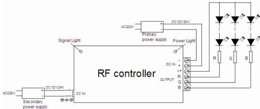
**ПРЕДУПРЕЖДЕНИЕ: ЗАПРЕЩЕНО ОСУЩЕСТВЛЯТЬ ОДНОВРЕМЕННОЕ ПОДКЛЮЧЕНИЕ ИСТОЧНИКОВ ПИТАНИЯ ЧЕРЕЗ РАЗЪЕМ И ЧЕРЕЗ КЛЕММНУЮ КОЛОДКУ.**
