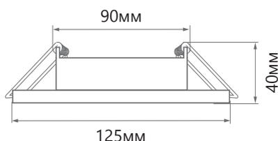
Светодиодный светильник CD9902 разработан специально для натяжных потолков и подвесных систем. Применяется как для декоративной подсветки, так и для основного освещения помещений. Особенностью новых моделей светильников является подсветка корпуса при помощи светодиодной ленты расположенной по периметру светильника, что обеспечивает возможность отдельного включения светодиодной подсветки или лампы (при подключении к разным выключателям).
