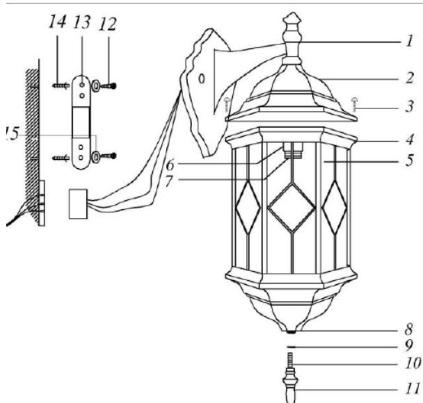
1 – рожок; 2 – крышка; 3 – винты; 4 – ламподержатель; 5 – патрон; 6 – каркас;
