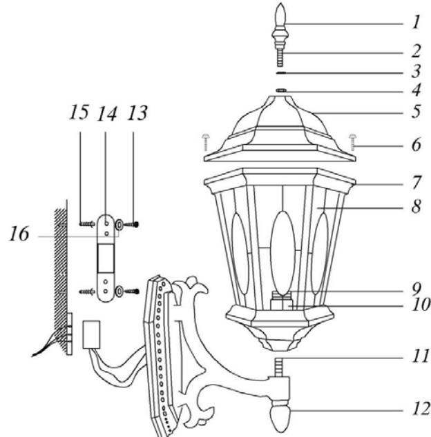
1 – декоративная балюсина; 2 – полый резьбовой крепеж; 3 – гровер; 4 – гайка; 5 – крышка; 6 – винты; 7 – металлический каркас светильника; 8 – стеклянный рассеиватель светильника; 9 – патрон; 10 – лампадодержатель; 11 – полый резьбовой крепеж; 12 – декоративная балюсина; 13 – саморезы; 14 – крепежная скоба; 15 – фиксаторы саморезов; 16 – шайба.
