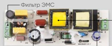
Обеспечивает широкий диапазон рабочих напряжений
