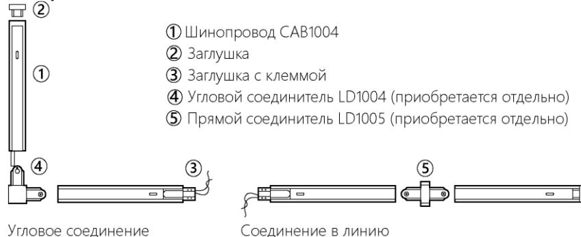
4.8 Установите светильники на шинопровод. Для предотвращения появления повышенных механических напряжений в конструкции шинопровода, светильники необходимо распределять равномерно по всей длине.
