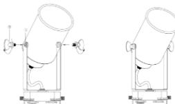
Закрепите кронштейн светильника при помощи специального винта с двух сторон.
