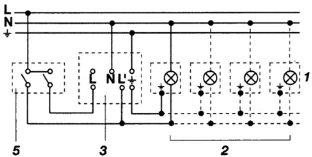
3. Подключение через переключатель на несколько направлений для ручного и автоматического режима
