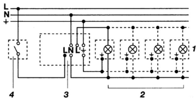
1. Светильник без нулевого провода
