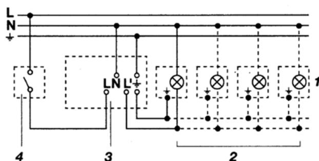
2. Светильник с имеющимся нулевым проводом
