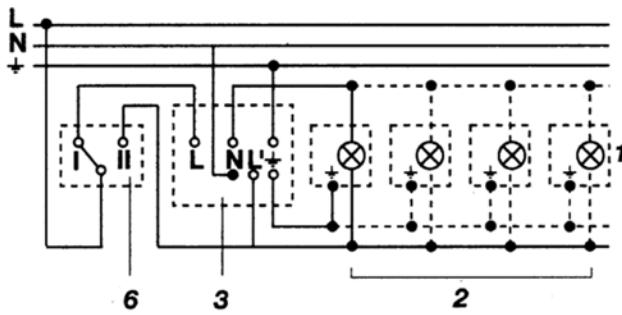
4. Подключение через переключатель включения и выключения лампы для режима постоянного освещения и автоматического режима
