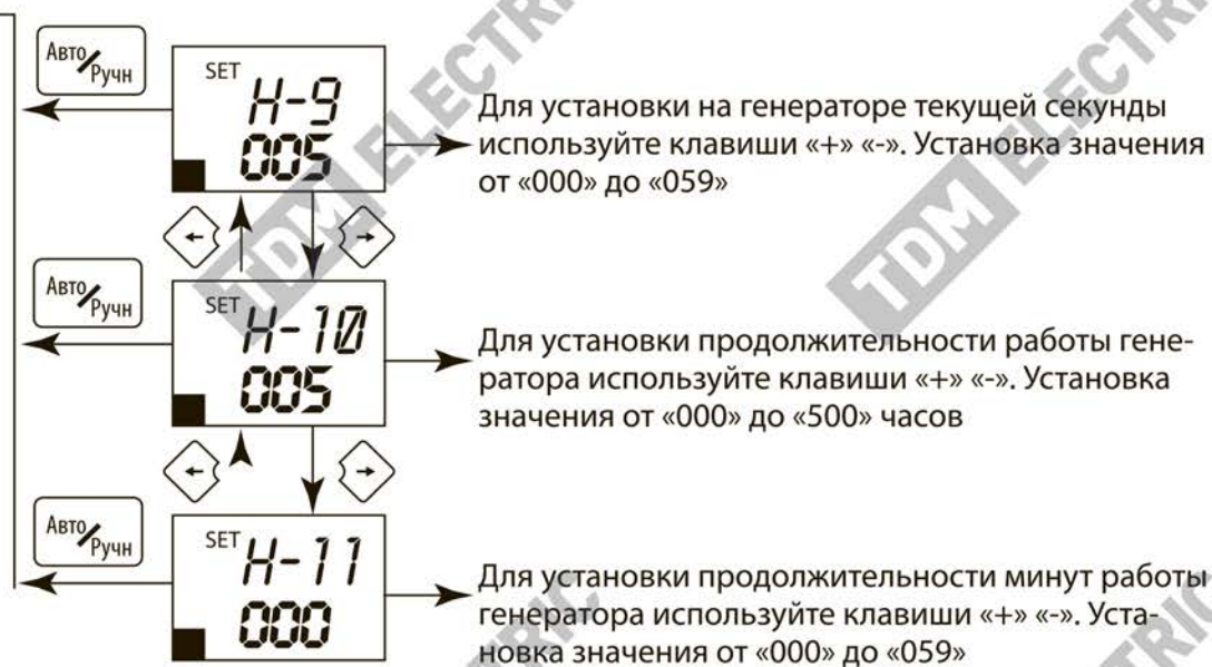
Рисунок 7. Режимы работы АВР-ПНД, установка режимов работы генератора
