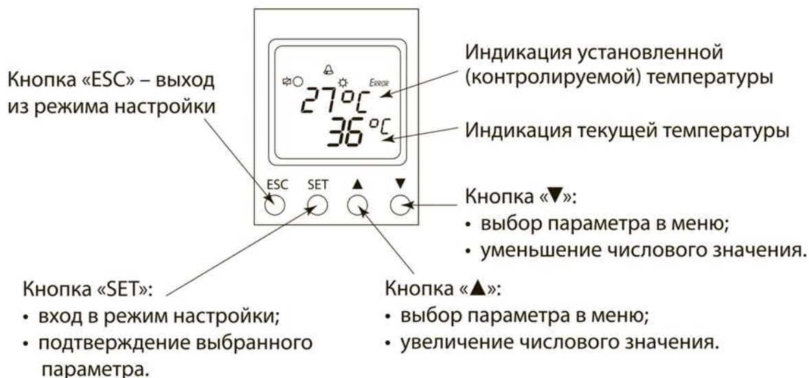
Рисунок 6. Показания дисплея реле PT-820M
